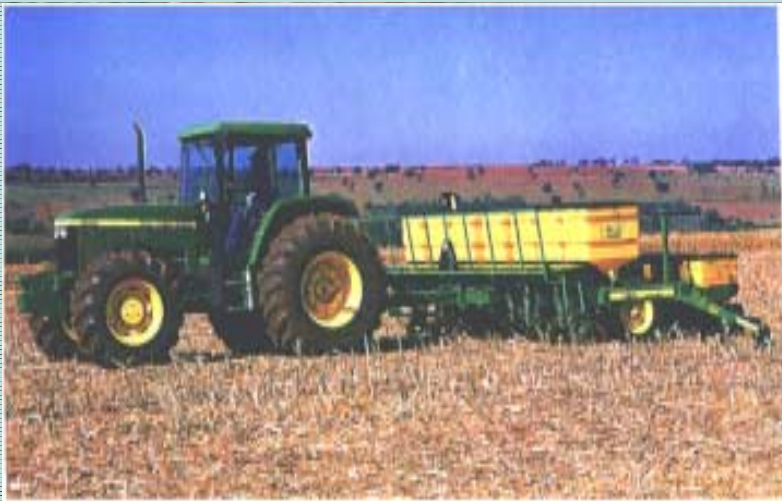
Plantadeira PD planta em palha dessecada
